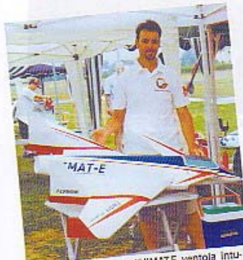
Osvaldo Gotta, con l'HIMATE ventola intubata elettrica Schubeler DS94.HDT da 120 mm di diametro. Motore Neumotor 1521-2Y Potenza 3,7 Kilowatt con 92 ampere di assa a 32000 giri ed una spinta statica di 6 kg.
