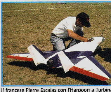
Il francese Pierre Escalas con l'Harpoon a Turbina con tentativo di orientare il getto per il decollo. Turbina Simjet da 8 kg.
